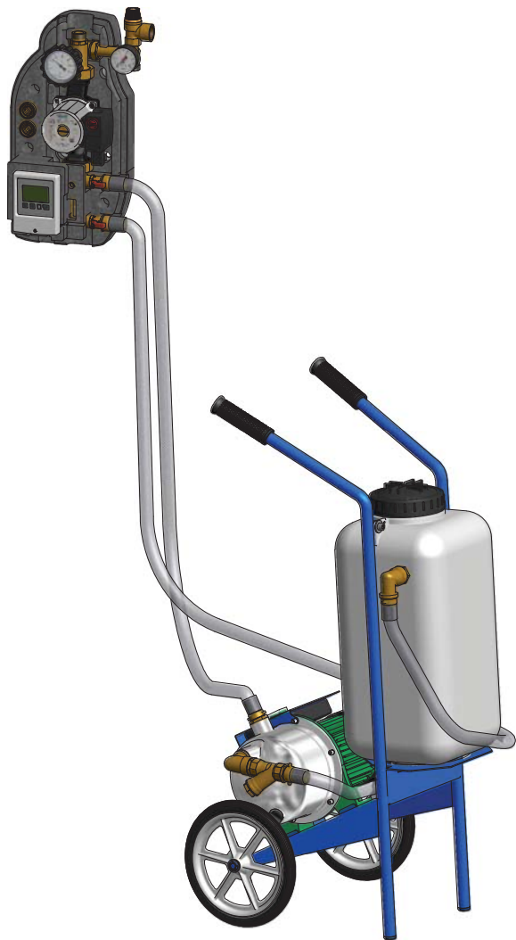
Obr. 34: Plnění solárního systému
