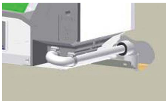
Obr. 17: Připojení trubky 22 mm na odpad
