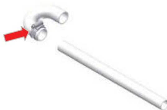
Obr. 16: Montáž hadice na kondenzát ve tvaru U
